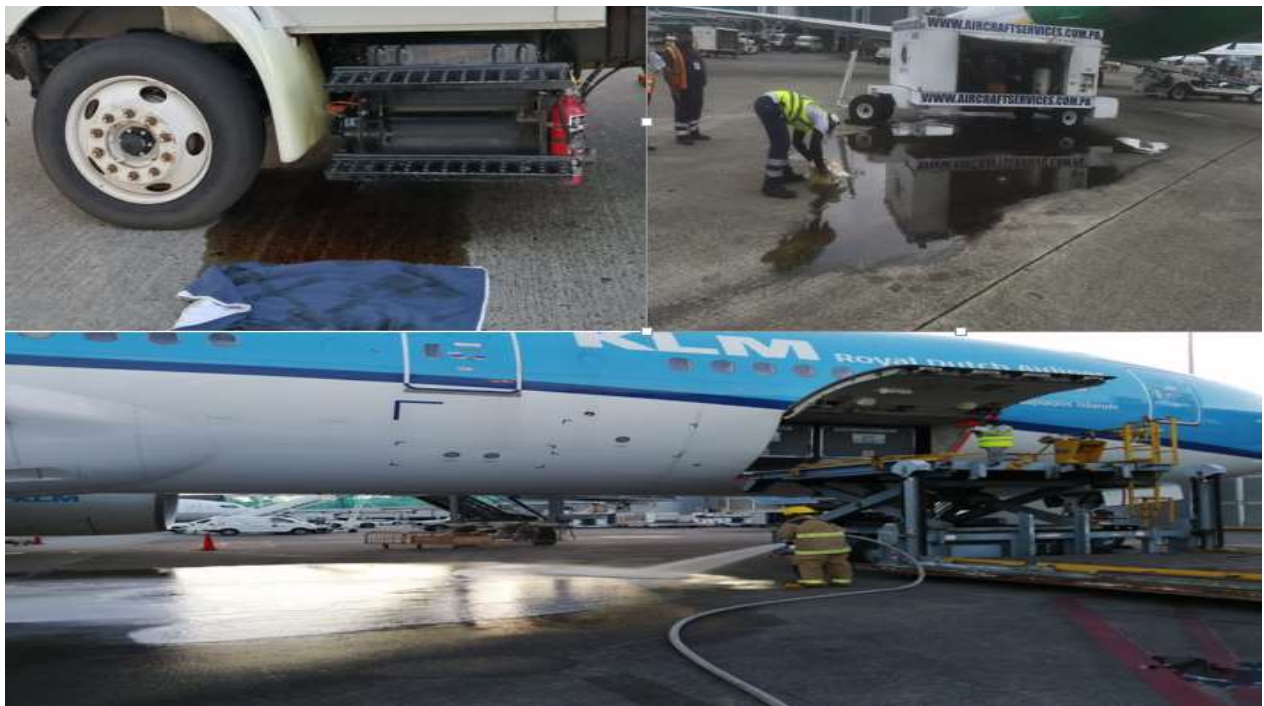
Figura 5: Derrame de Hidrocarburo en Plataforma AIT
