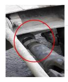
Cubre polvo que conecta eje diferencial 1 y 2 defectuoso. Caucho de tensor del diferencial defectuoso
