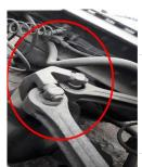
Caucho o bushing de tensor del diferencial defectuoso
