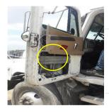
Mal estado interna de la cabina, vidrios no suben y falta de orden y Limpieza
