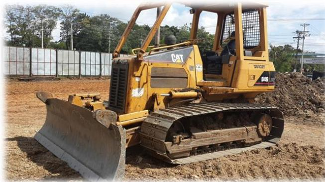
Máquina autopropulsada sobre orugas o sobre ruedas con un equipamiento que posee un accesorio con una hoja que corta, desplaza y nivela materiales mediante el movimiento de
