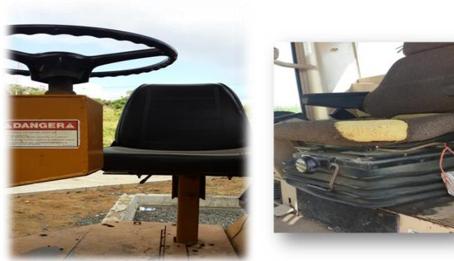
Los asientos que se presentan en las imágenes son de los equipos pesados utilizados en la empresa, como se puede observar en la imagen izquierda el mal estado de los mismos y la imagen derecha muchos de los asientos no disponen de un sistema de suspensión y amortiguación para reducir los niveles de vibraciones en los operadores de equipos pesados.
